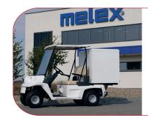
Dimensions équipement 0,82x1,12x1 m Capacité chargement 200 kg Nombre de places Plomb ou lithium 48 V utonomie Vitesse max. 57 km 27 km/h
