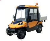
Dimensions véhicule 3,005x1,39 m Dimensions équipement 0,95x1,17x0,25 m Capacité chargement 250 kg Batterie 250 kg Moteur 3.3 ou 5 kW Autonomie 61 km
