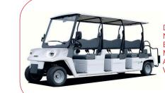
Dimensions véhicule 4,62x1,25 m Nombre de places 5 kW 61 km 25 km/h
